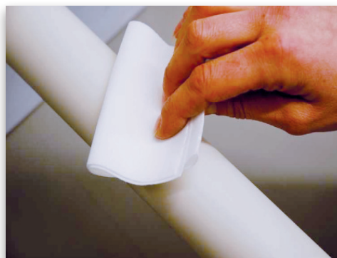
Einfache Reinigung: Mit Wasser waschen und mit einem Walzenreinigungstuch nachwischen.
